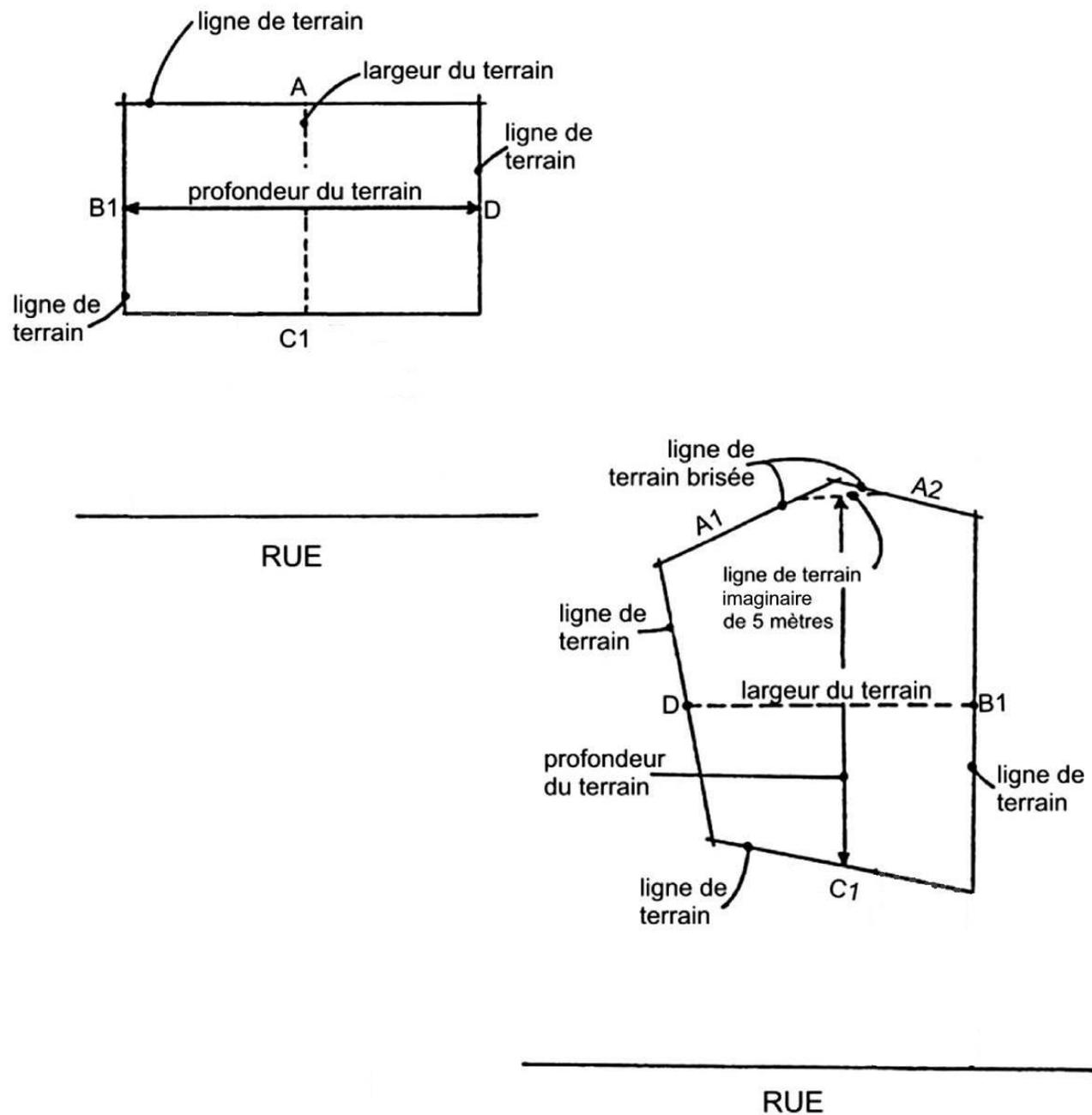
Dans le cas d'un terrain enclavé, la profondeur du terrain correspond à la distance la plus grande entre le point milieu des lignes opposées compris dans l'aire délimitée par les segments A, B1, C1 et D et A1, A2, B1, C1 et D selon le cas. La largeur du terrain correspond à la distance comprise entre le point milieu entre les autres lignes opposées comprises dans l'aire mentionnée précédemment.
