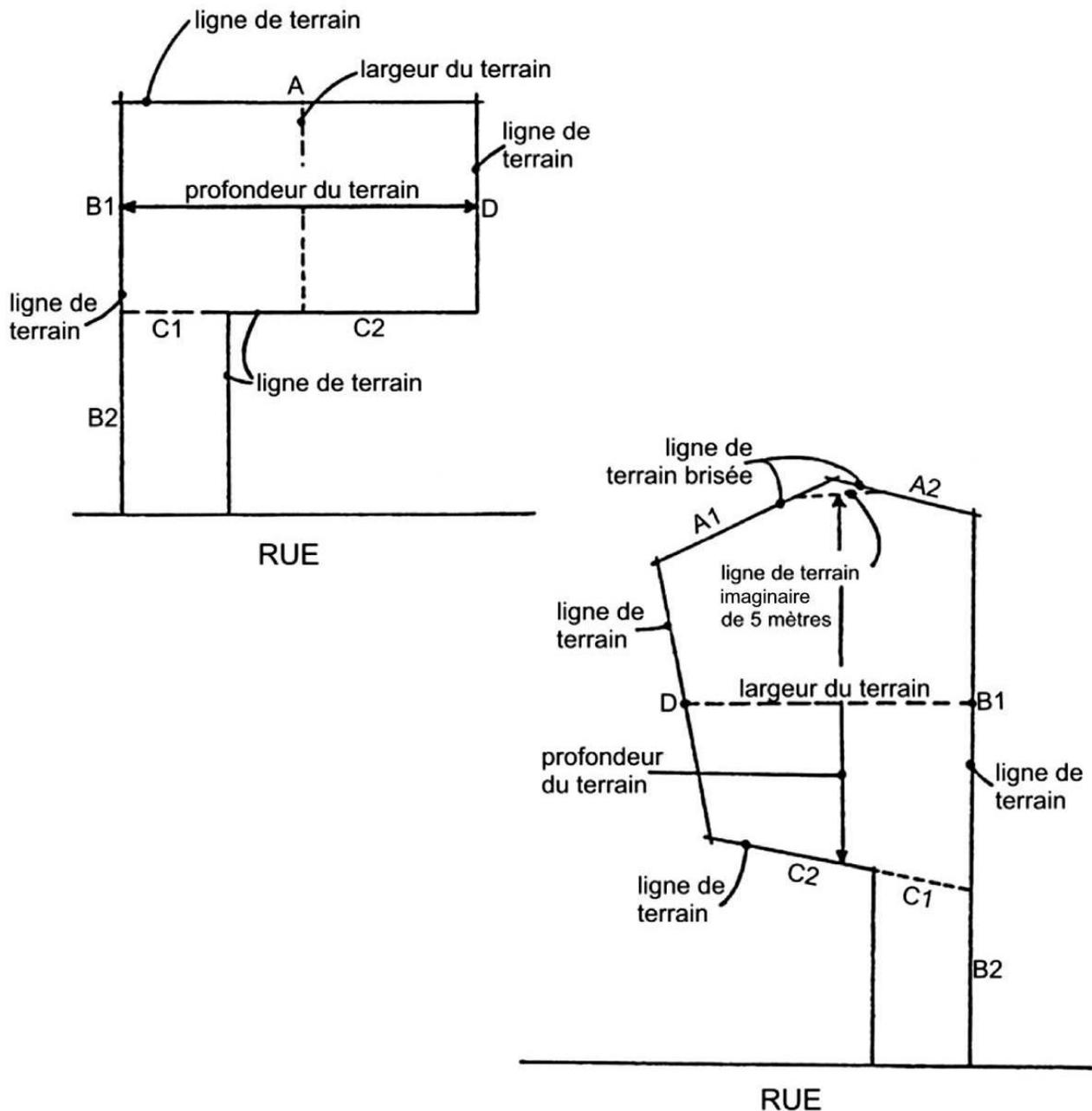
Dans le cas d'un terrain partiellement enclavé, la profondeur du terrain correspond à la distance la plus grande entre le point milieu des lignes opposées compris dans l'aire délimitée par les segments A, B1, C1, C2, D et A1, A2, B1, C1, C2, D selon le cas. La largeur du terrain correspond à la distance comprise entre le point milieu entre les autres lignes opposées comprises dans l'aire mentionnée précédemment.
