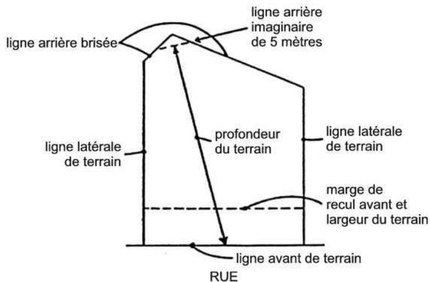
La profondeur du terrain est calculée entre le point milieu de la ligne avant de terrain et le point milieu d'une ligne arrière imaginaire de 5 mètres de largeur joignant le segment d'une ligne arrière brisée et perpendiculaire à la profondeur.
