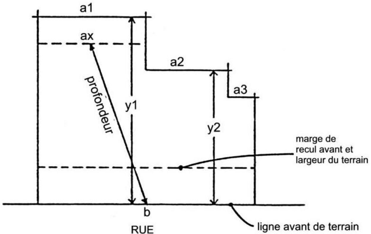
Si la longueur du segment de la ligne arrière de terrain la plus éloignée (a1) représente 50 % ou plus de la ligne avant de terrain (b), la profondeur du terrain correspond à la distance entre le point milieu de la ligne avant et le point milieu d'une ligne arrière moyenne  $ax = \frac{y1 + y2}{2}$
